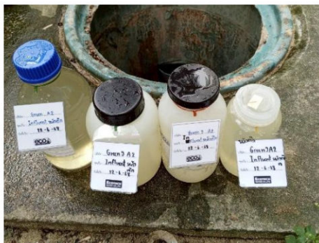
น้ำเสียก่อนเข้าระบบบำบัด (Influent) หลังอาคาร เอ 2
